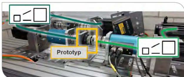
Testing von leistungsskalierten Prototypen auf dem IPEK-sCiL-Prüfstand
