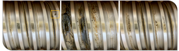
Spindelzustände. Links: Kleines Pitting, Mitte: Starke Verschmutzung, rechts: Pitting-ähnliche Verschmutzung (Bild: KIT)
