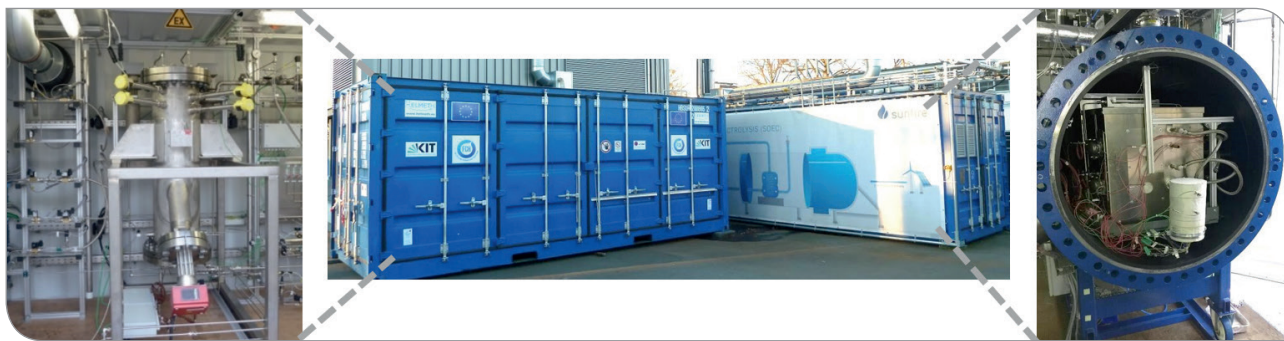
Prototyp bestehend aus dem Methanisierungs- (linker Container) und dem Elektrolysemodul (rechter Container)
